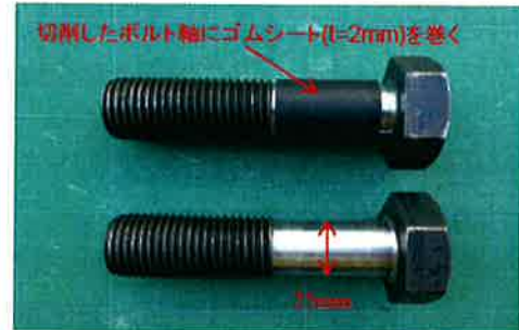
写真 2.2.9 図上部の固定用ボルト
