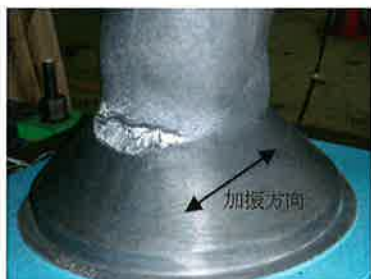
写真 2.2.4 振幅毎の亀裂一例(振幅400mm、3サイクル後)
