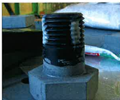
写真 2.1.4 接着剤塗布状況
