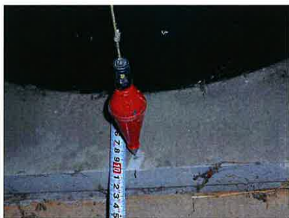
写真8. 免震層上部躯体の乾燥収縮による変形の事例
