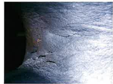
写真 2.2.6 振幅毎の亀裂一例(振幅5mm、9000回時)
