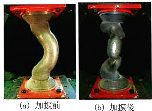
写真 2.2.8 NO1 P 方向 (±150mm 100 サイクル)
